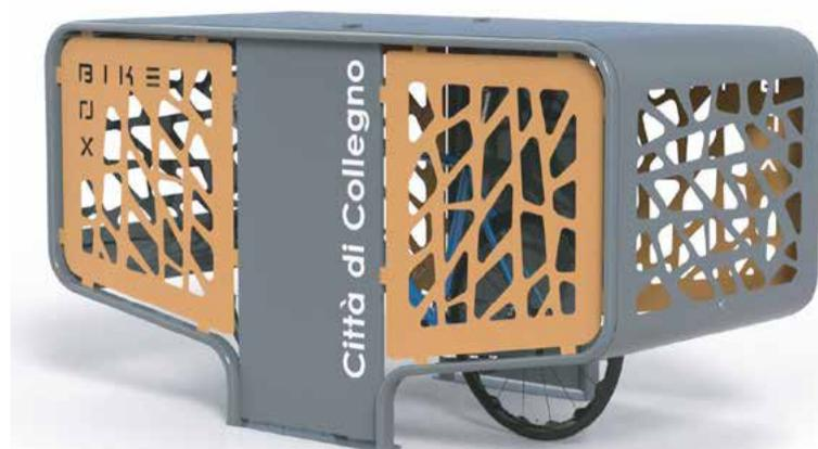
Modulo in acciaio zincato per ricoverare 1 bicicletta. Dotato di chiusura a chiave (chiave incorporata che si sgancia solo a BOX chiuso) e di ganci per assicurare la bici per mezzo catena o lucchetto. Il Box è dotato di fori per il fissaggio al suolo a mezzo tirafondi e tasselli ad espansione.
