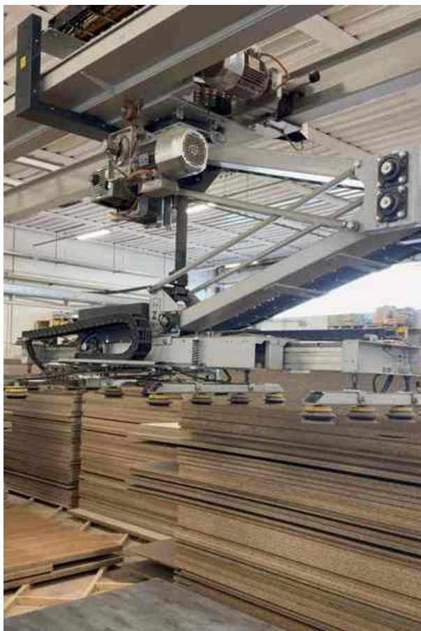
carico delle lastre tramite braccio robotico
