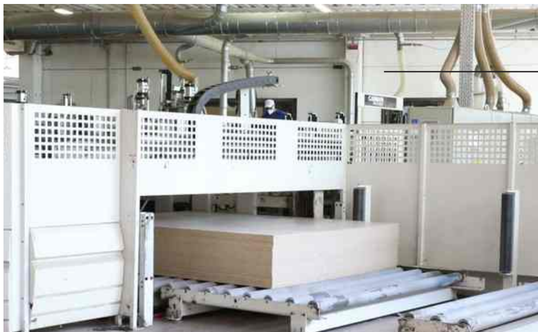
carico automatico del nobilitato in lastre.
