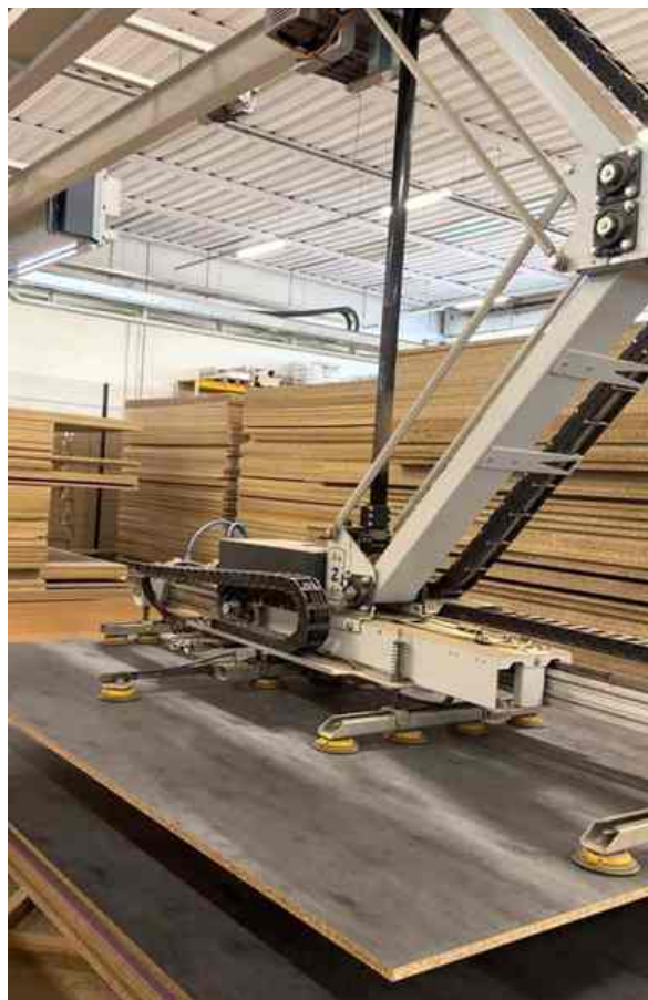
carico delle lastre tramite braccio robotico
