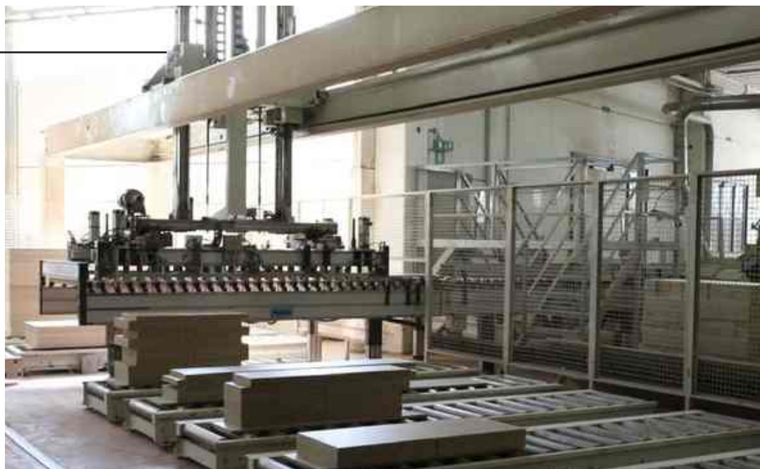
scarico automatico pannelli sezionati.
